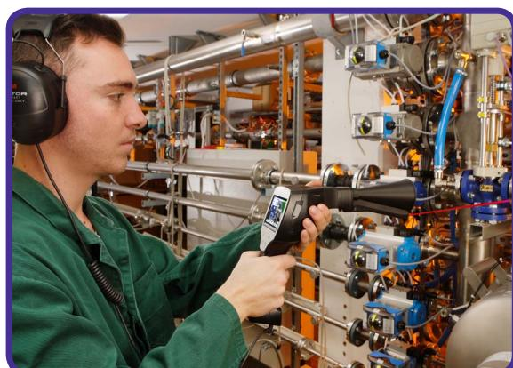
防噪音头戴式耳机还可以在极端嘈杂的环境中进行泄漏检测。环境噪音会消失，泄漏（听不见的超声波）将转化为可听信号。激光准确定位。
